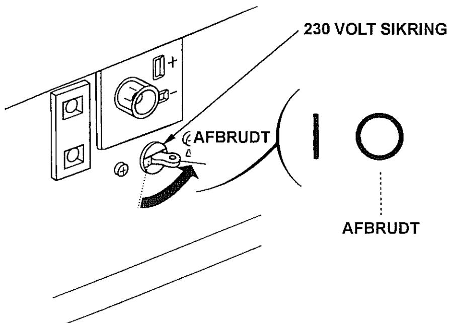
2. Sluk for det tilsluttede udstyr og tag udstyret ud af 230 volt stikkene på generatoren.
