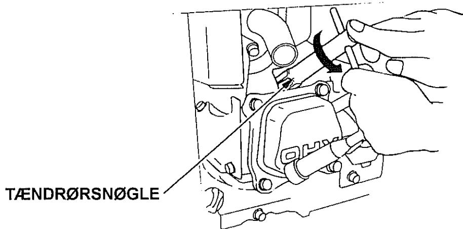
4. Undersøg tændrøret. Smid det væk, hvis porcelænet er krakeleret eller revnet. Rens tændrøret med en stålbørste, hvis det kan anvendes igen.
